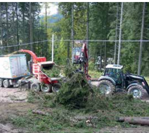
Caricamento del cippato in bosco destinato alla centrale di teleriscaldamento
