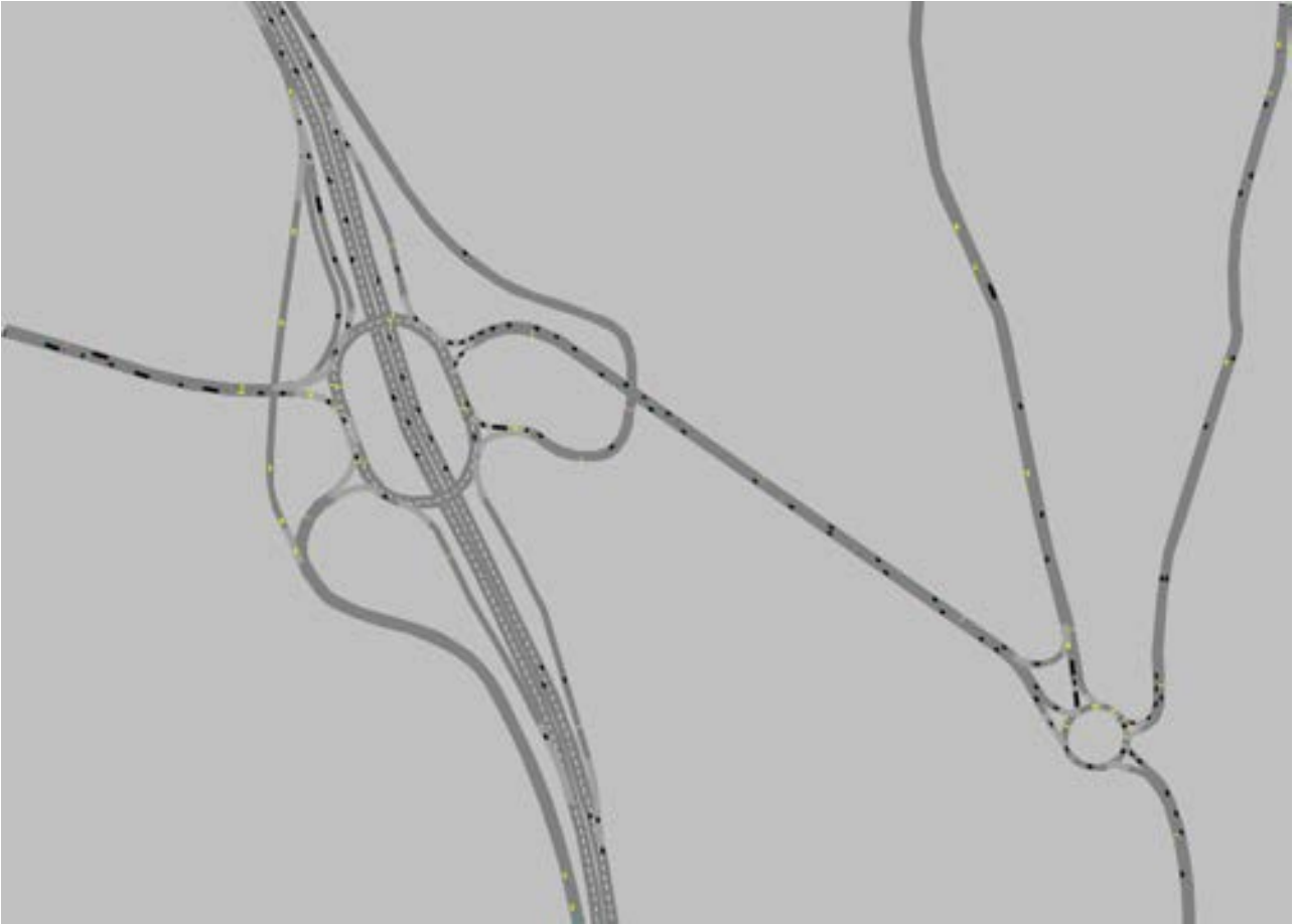
Figura 50. Schema della situazione al minuto 10 della simulazione: stato di progetto – sito via San Vincenzo. Ipotesi con bretella tra tangenziale e Via Lidorno.
