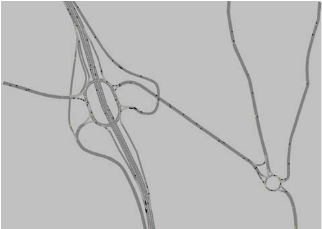
Figura 55. Schema della situazione al minuto 30 della simulazione: stato di progetto – sito via San Vincenzo. Ipotesi con bretella tra tangenziale e via Lidorno.
