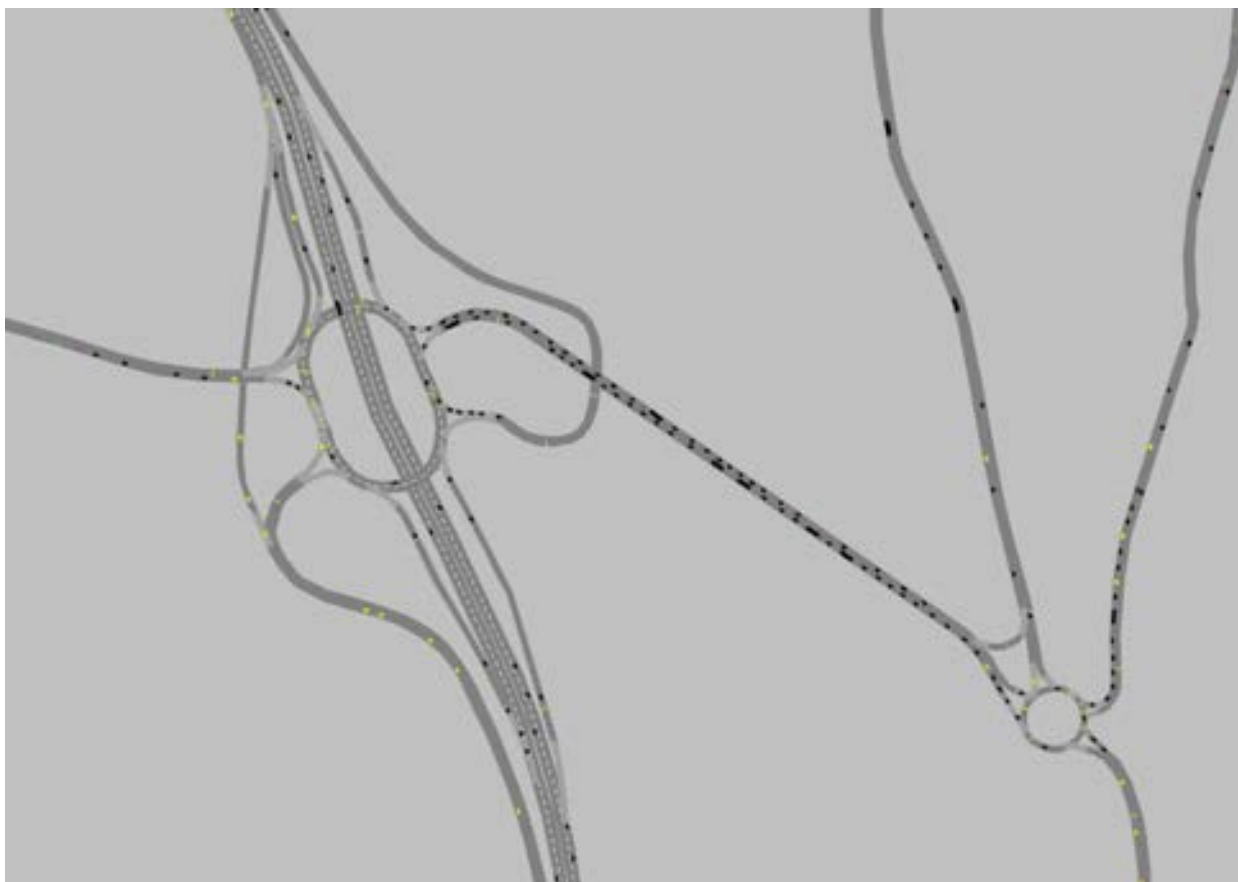
Figura 62. Schema della situazione al minuto 60 della simulazione: stato di progetto – sito via San Vincenzo. Ipotesi utilizzo TPL ridotto al 10% - maggiore carico sulla rete pari a circa 150 v/h.
