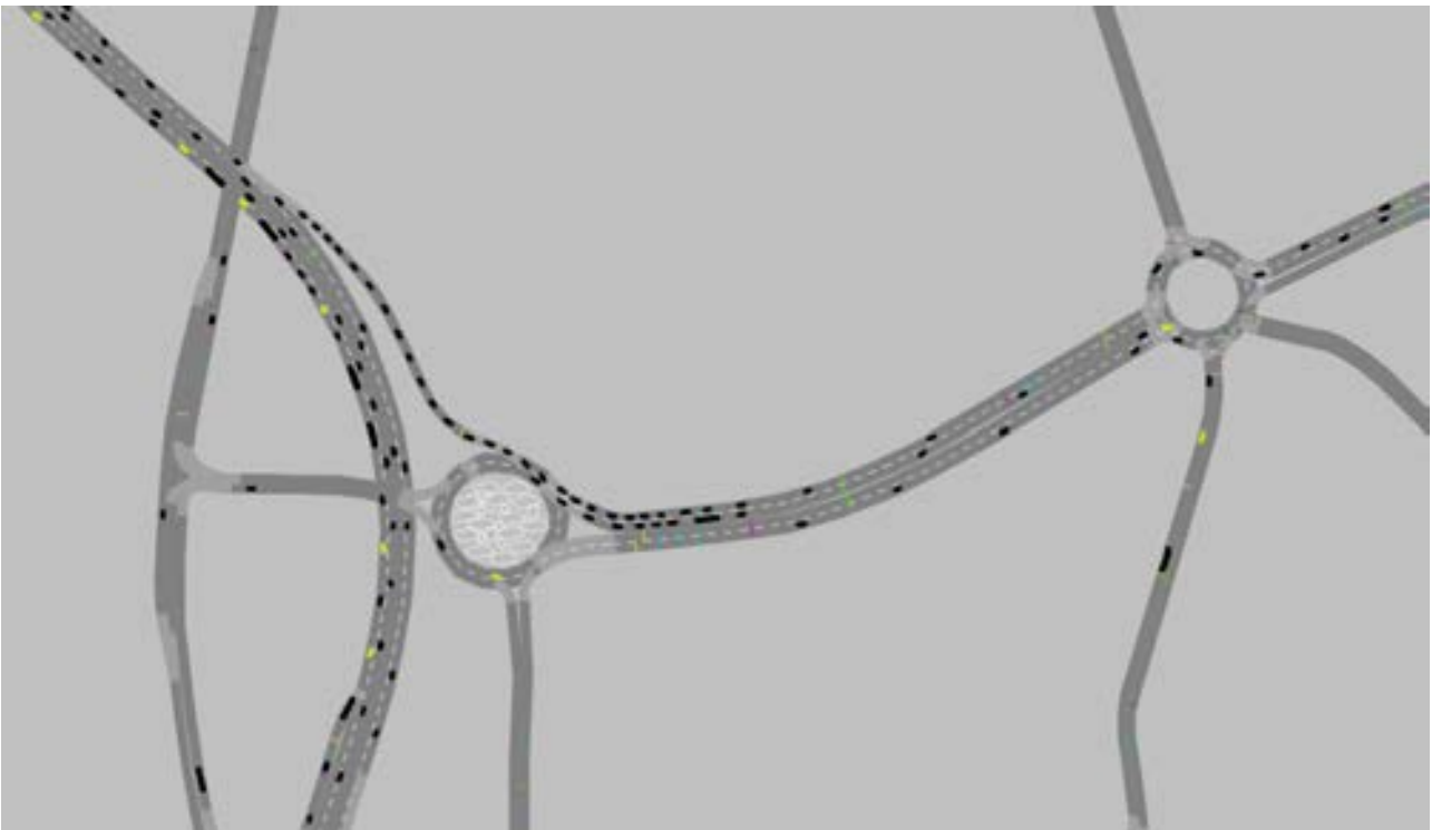
Figura 36. Schema della situazione al minuto 10 della simulazione: stato di progetto – sito via al Desert (incremento di flussi da via Degasperi pari a 278 v/h, pari ad un incremento del 25% rispetto alla situazione attuale)
