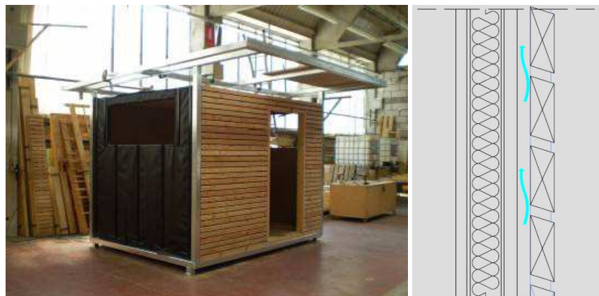
Struttura e rivestimento – Schema parete ventilata
