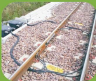
L'impianto ATP svolge pertanto funzioni di protezione della marcia del treno per evitare danni a persone o cose che possano derivare da collisioni per inosservanza dei segnali o deragliamenti dovuti ad eccessiva velocità.
