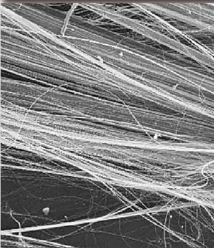
L'**AMIANTO** è un minerale largamente utilizzato in passato (in particolare tra il 1960 e il 1985) nella costruzione e nelle coperture degli edifici, spesso per ottenere isolamento termico, acustico o a scopi antincendio.
